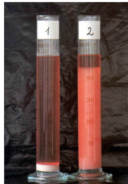
Rigonfiamento in liquido dopo 4h 1) cellulosa polvere 2) FITOFLOC® DC
